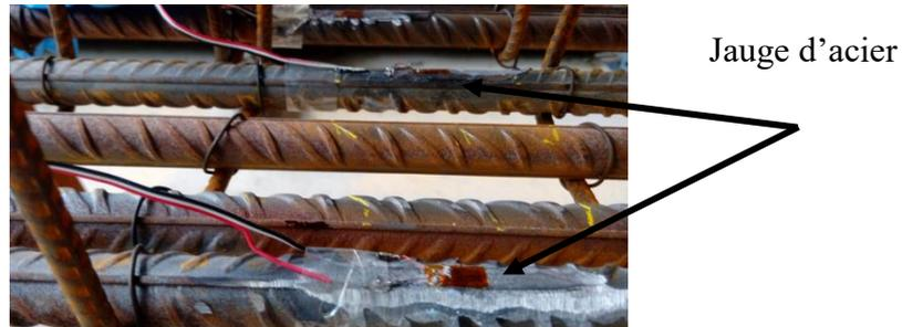
Figure 18 : Instrumentation des barres d'acier.
