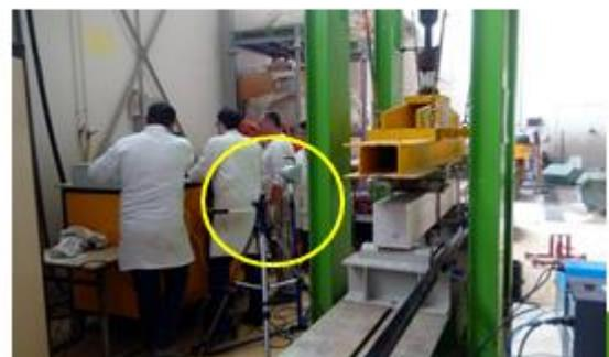
Figure 20 : Dispositif de l'essai de flexion 4 points.
