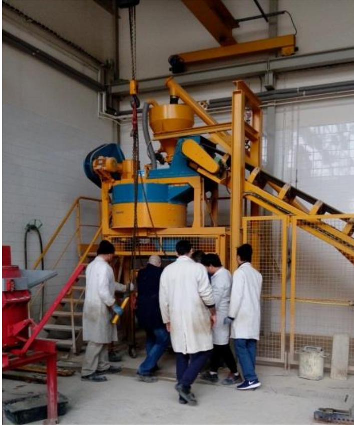
Figure 16 : Centrale à béton.
