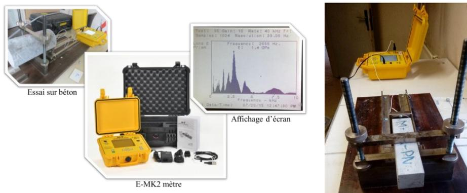
Figure 40. Dispositif de mesure du module d'élasticité dynamique.
