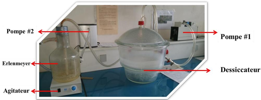
**Figure 32.** Schéma illustratif du système de mesure de la porosité sous vide.
