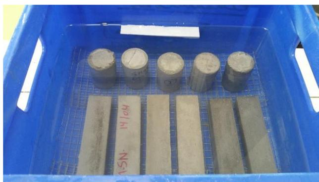
**Figure 34.** *Conservation des éprouvettes dans des bacs remplis d'eau.*
