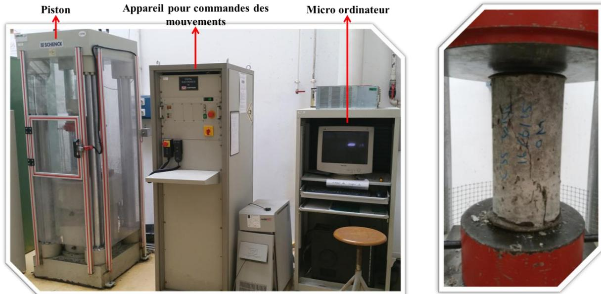
**Figure 59.** Photo illustrant le fonctionnement d'essai de compression à l'aide de SCHENCK
