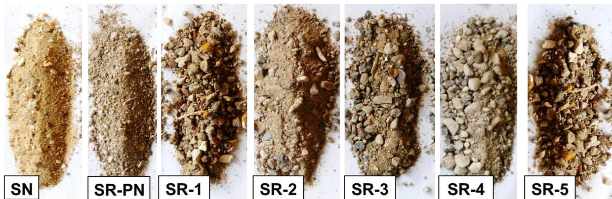
**Figure 7.** Les différents sables recyclés utilisés pour la formulation des mortiers.
