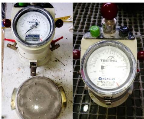
Figure 21. Aéromètre.
