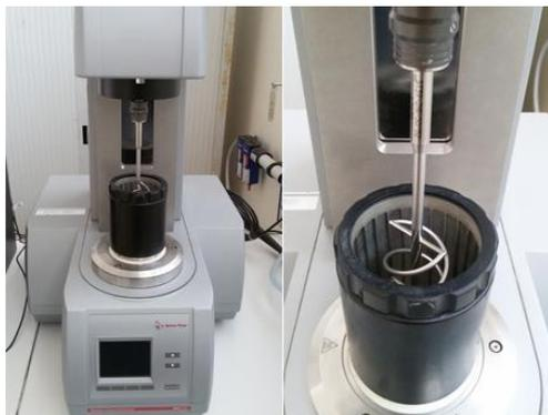
**Figure 23.** Rhéomètre Anton Paar avec la géométrie double-hélice (ST39).
