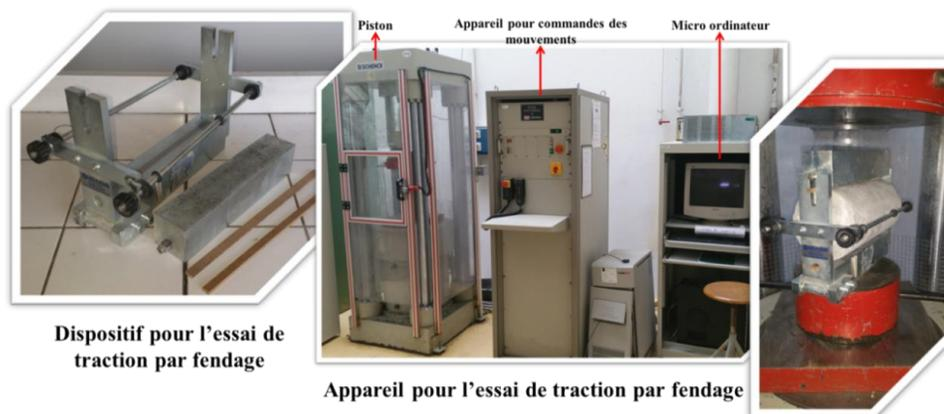
**Figure 62.** Dispositif pour l'essai de traction par fendage.
