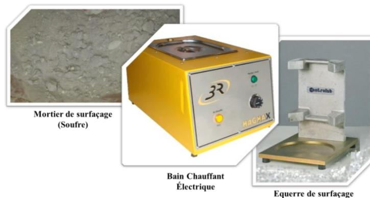
**Figure 60.** Dispositif pour surfacage d'une éprouvette.
