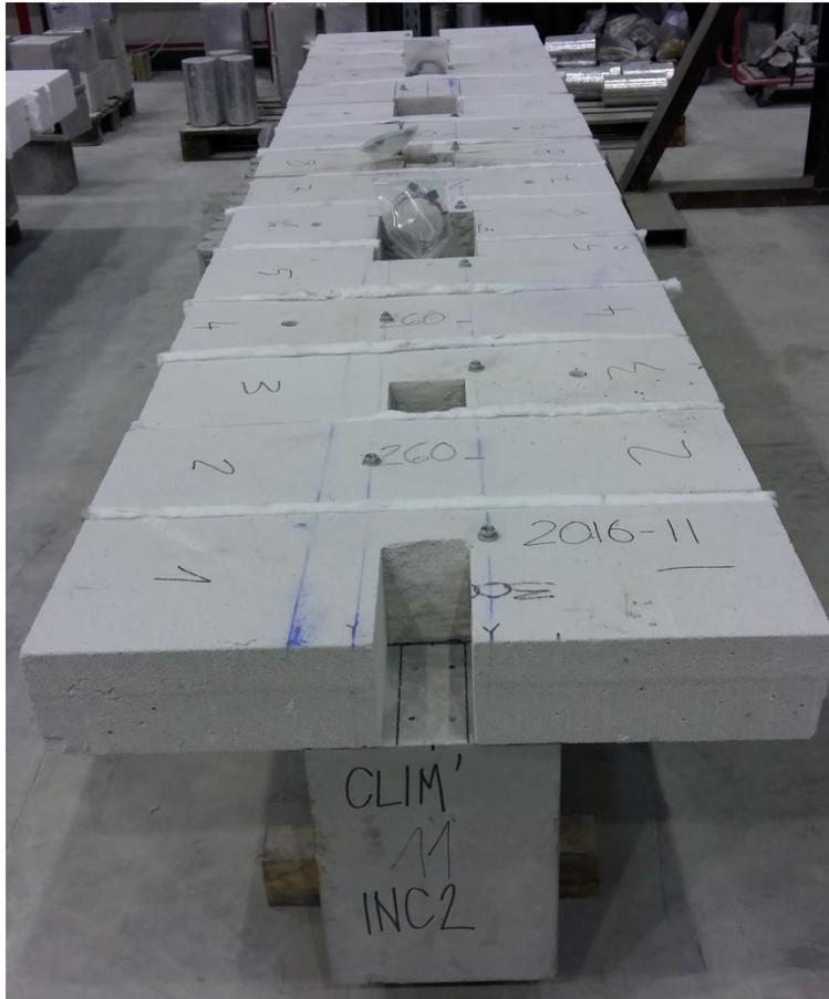
**Face non exposée de la poutre avant essai – partie supérieure de la poutre protégée par du béton cellulaire en partie supérieure**
