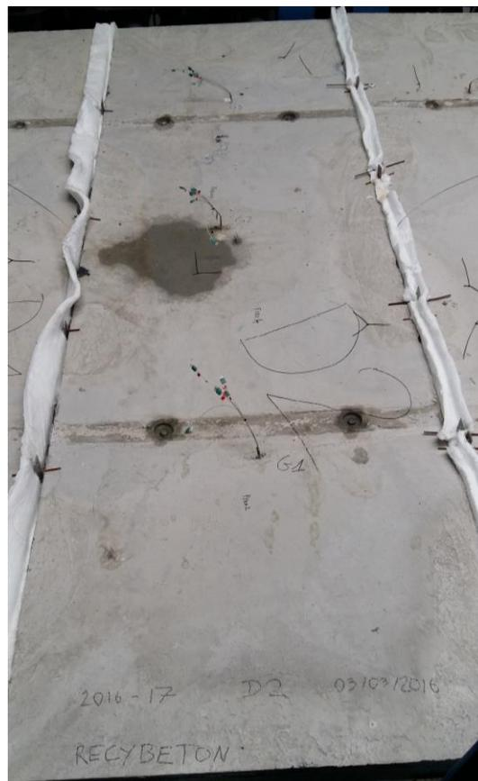
Photo de la face non exposée de la dalle D2 après essai
