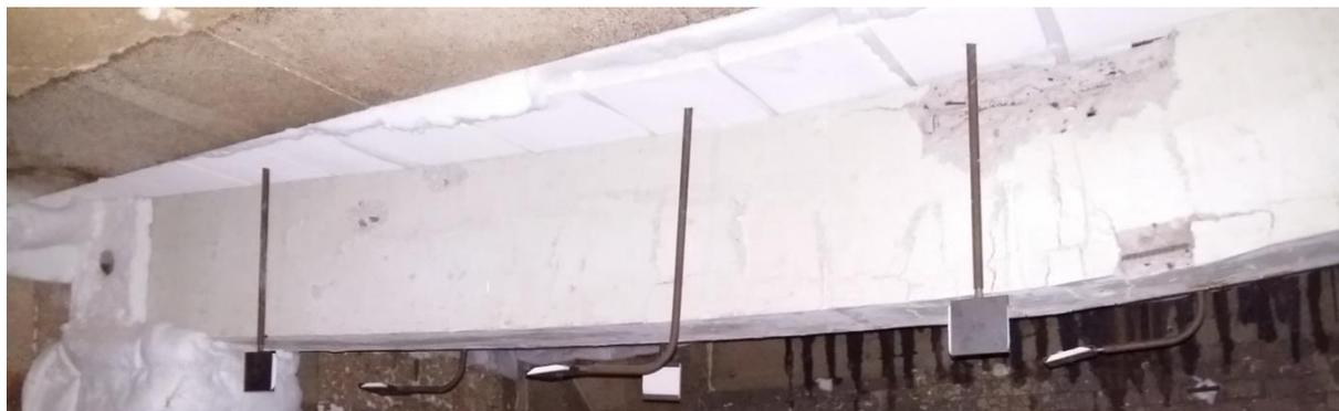
Figure 12 : poutre 0R/100R après essai
