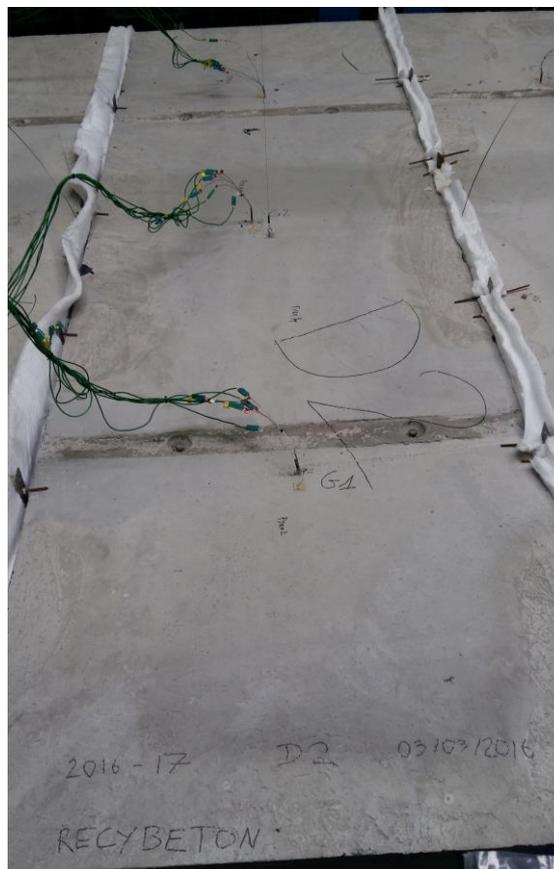
Photo de la face non exposée de la dalle D2 avant essai
