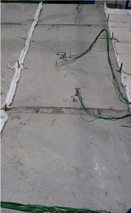
Photo de la face non exposée de la dalle D4 avant essai
