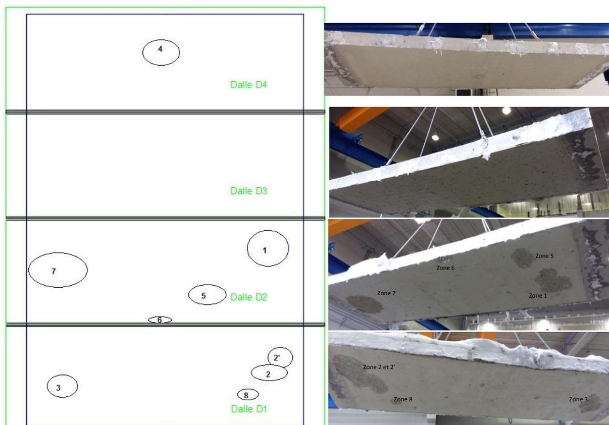
Figure 7 : Schéma des zones d'écaillage et photos des faces exposées au feu des dalles après essai et refroidissement
