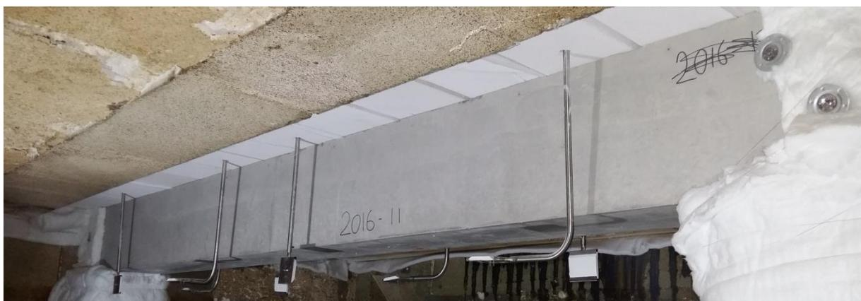
**Vues de côté d'une des faces exposées au feu de la poutre**
