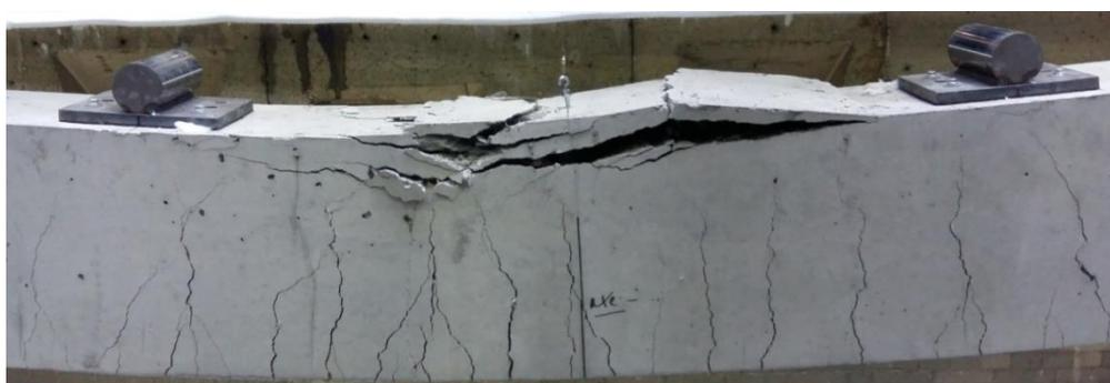
**Rupture de la poutre**
