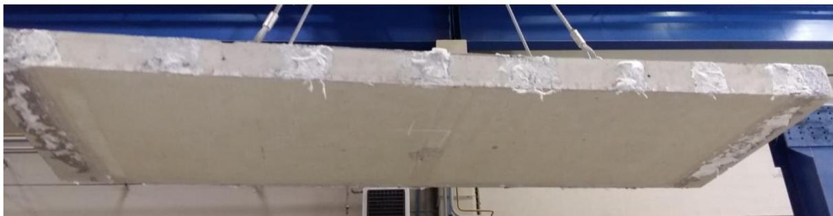
Photo de la face exposée de la dalle D4 après essai
