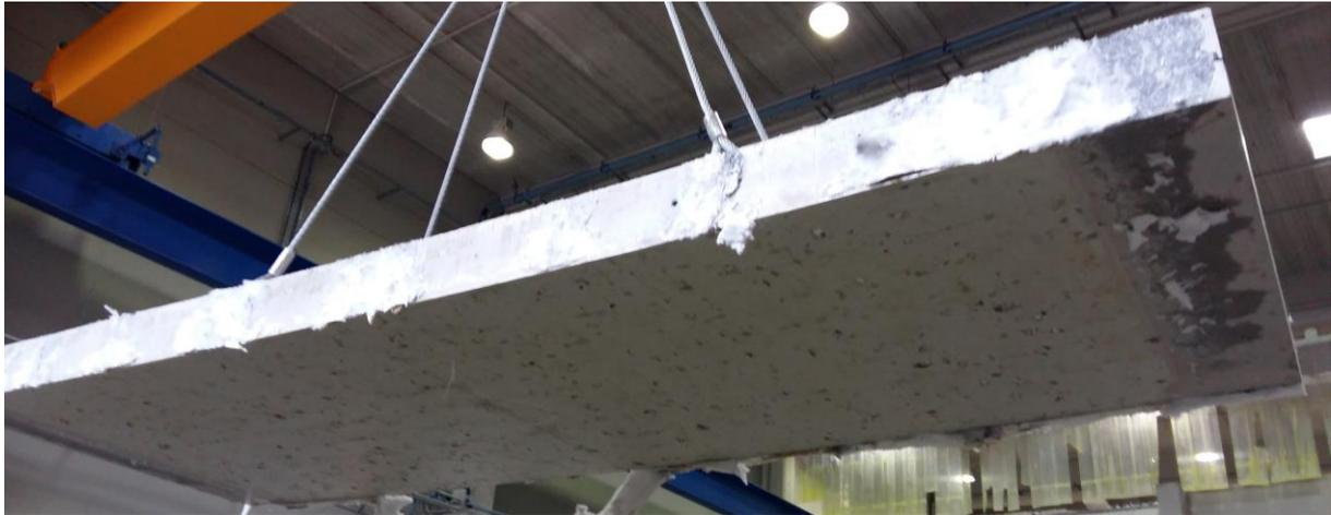
Photo de la face exposée de la dalle D3 après essai
