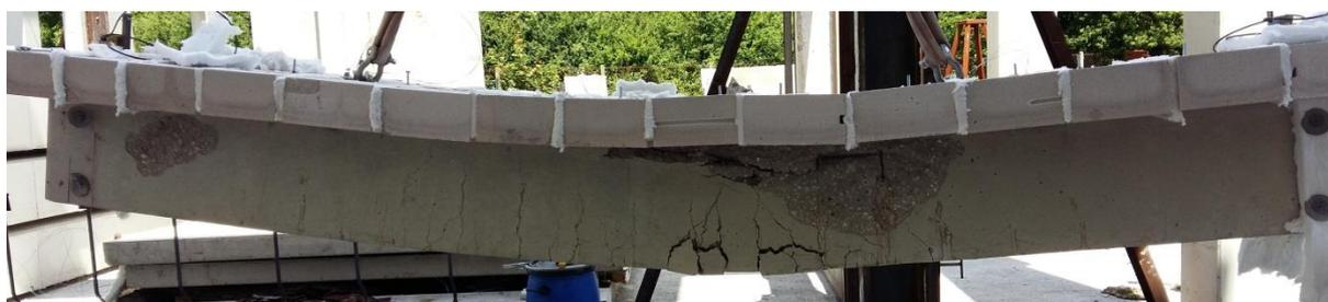
Figure 13 : poutre 30R/30R après essai
