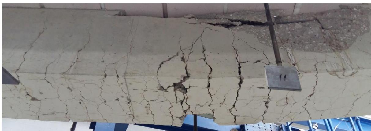
**Détail de la rupture de la poutre**
