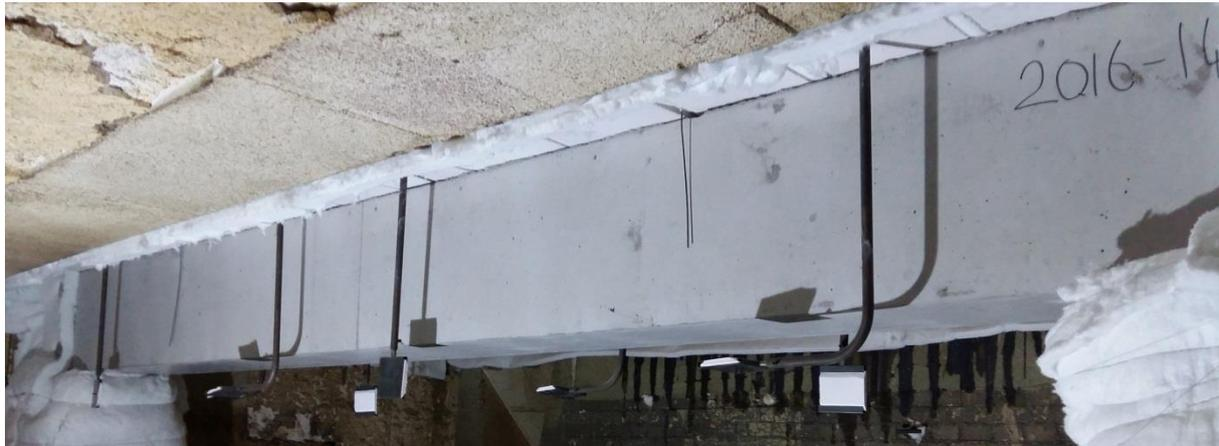
*Mise en place de la poutre avant essai*
