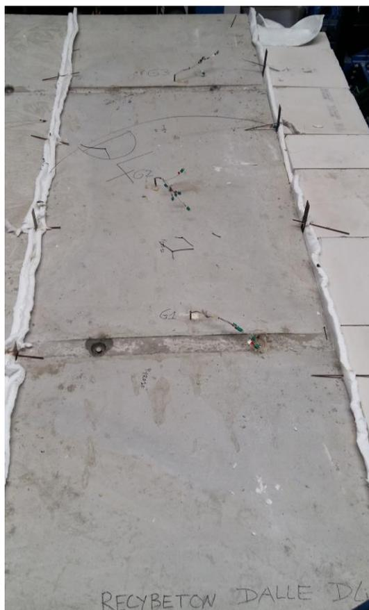
Photo de la face non exposée de la dalle D4 après essai
