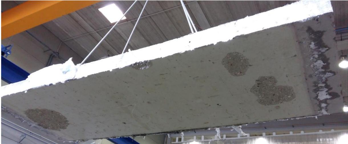
Photo de la face exposée de la dalle D2 après essai
