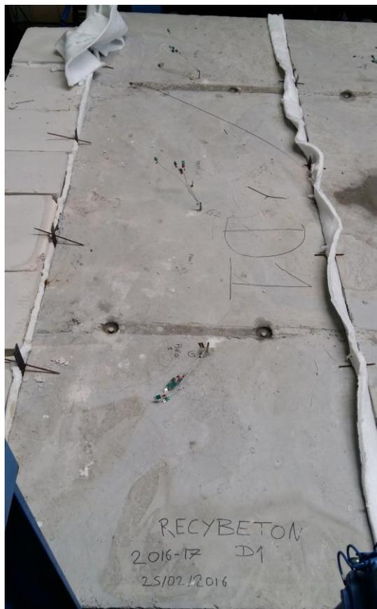
Photo de la face non exposée de la dalle D1 après essai
