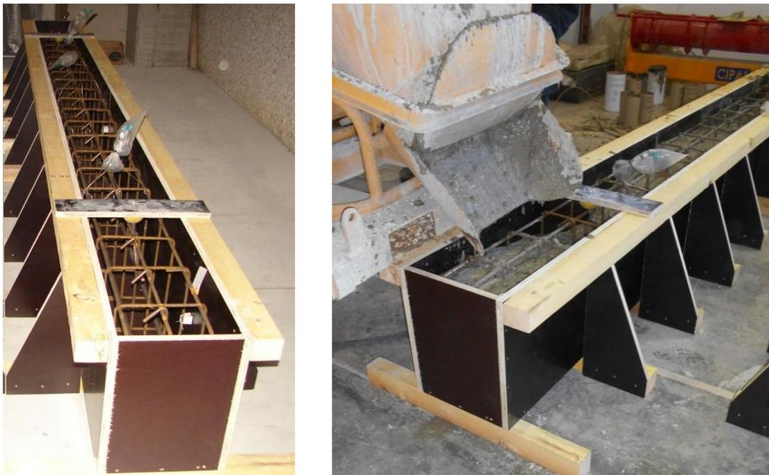
Figure 4 : Photos du coulage des poutres
