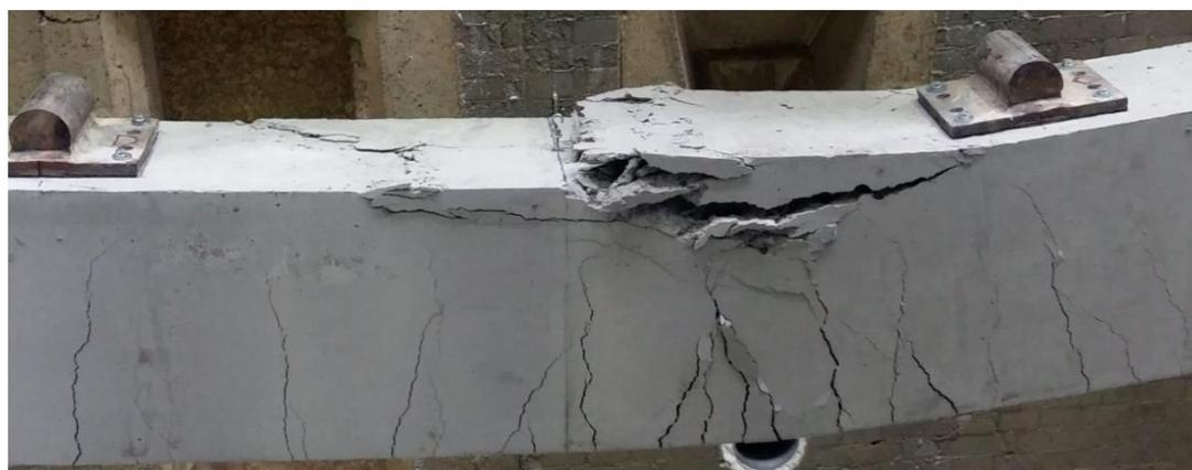
**Rupture de la poutre**
