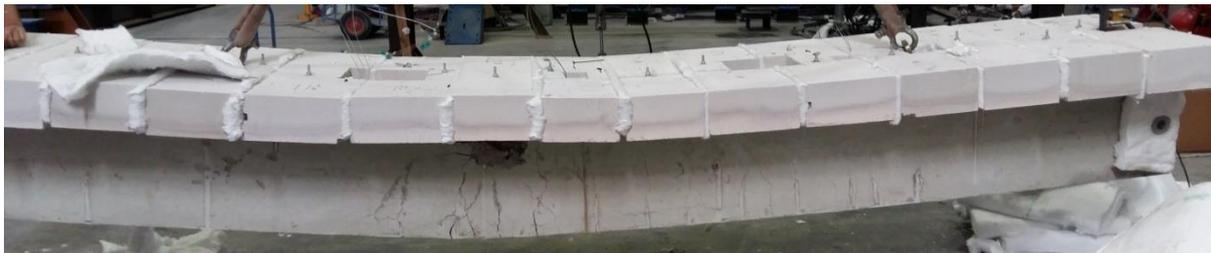
**Rupture de la poutre**
