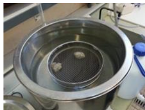
Figure 24 Traitement par ultra-sons
