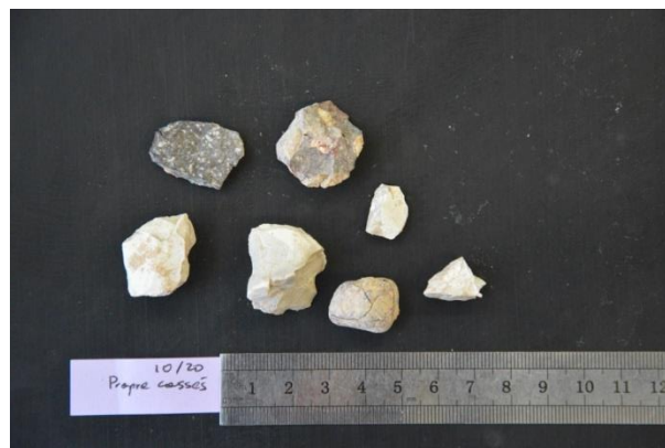
Figure 88 Endommagement des granulats Recybeton 10/20 « propres » - TTM chaud
