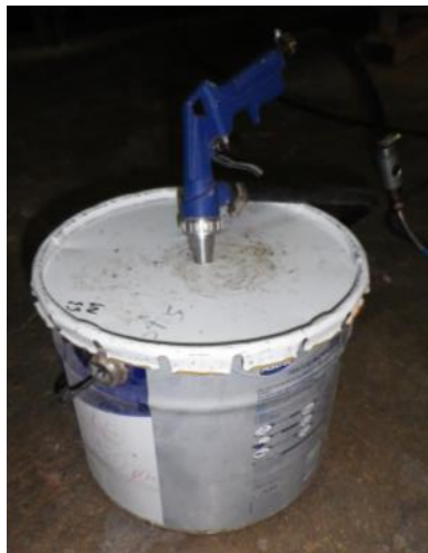
Figure 20 Équipement pour le sablage
