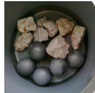
Figure 45 : Granulats "Homemade" avec 5 boulets d'acier dans le Micro-Deval, avant traitement mécanique
