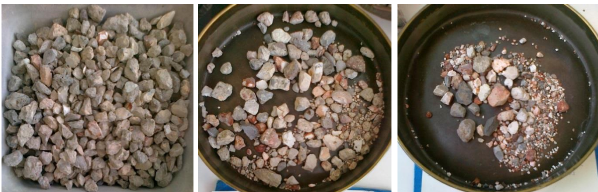
Figure 65 Test 19 Echantillons RecyBeton après traitement chaud, avant et après traitement mécanique micro Deval de 10 minutes avec : 2,5kg de billes) (test 19.1, \Delta m=17,90\% , \rho=2,29\text{g/cm}^3 ); ou 5 boulets (test 19.2, \Delta m=66,41\% , \rho=2,37\text{g/cm}^3 )
