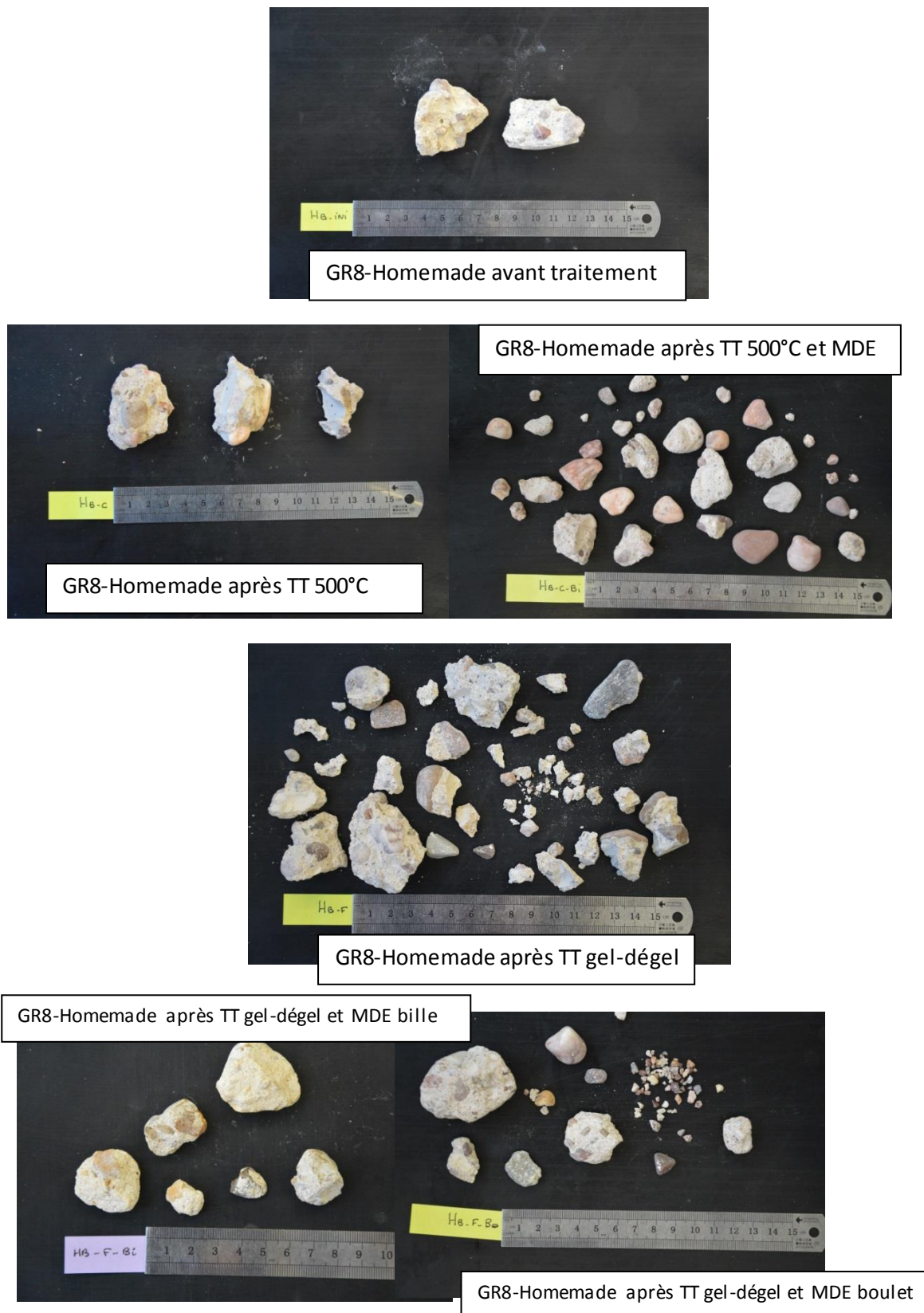
Figure 93 Evolution des Homemade GR8 20-40 mm à différentes étapes du traitement – contrôles visuels
