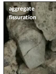
Figure 33 Aspect visuel des granulats après choc thermique à 500°C.
