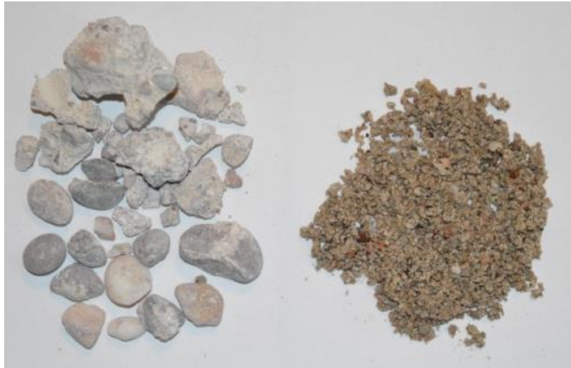
Figure 40 Échantillons après refroidissement en enceinte thermique
