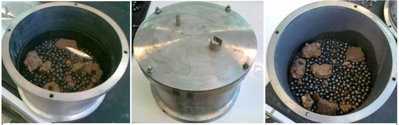
Figure 44 : Micro-Deval à l'eau avec des granulats "homemade" avec 2,5 kg de billes d'acier a) avant traitement b) MDE fermé c) après traitement
