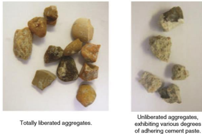
Figure 17 Principe du tri visuel
