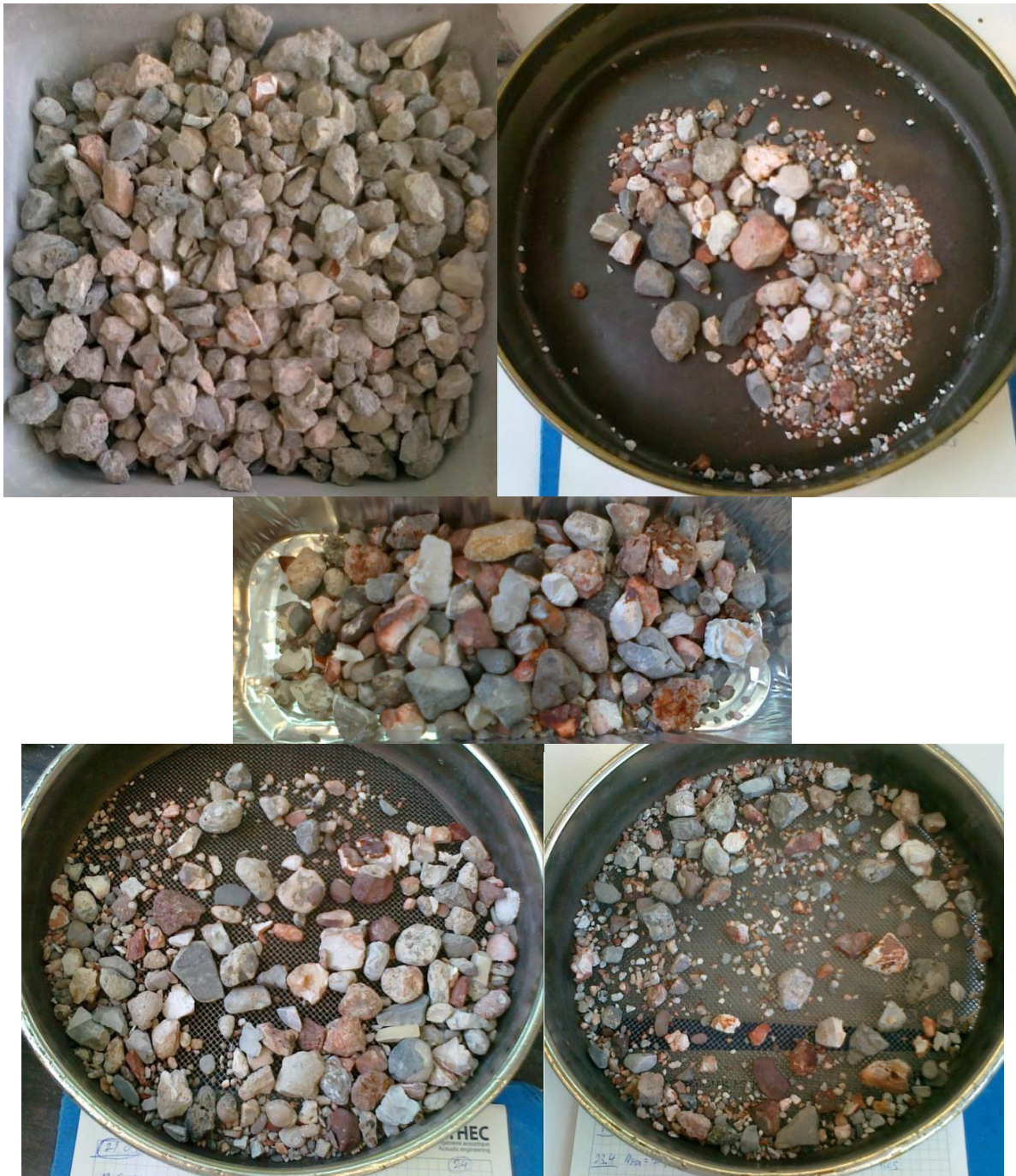
Figure 66 a: Test 19 échantillon avant traitement mécanique; échantillons après traitement mécanique b Test 19.2. ( \Delta m=66,41\% , \rho=2,37\text{g/cm}^3 ); c Test 19.4 ( \Delta m=38,73\% , \rho=2,36\text{g/cm}^3 ); d Test 19.6 ( \Delta m=29,37\% , \rho=2,34\text{g/cm}^3 ); e Test 19.7 ( \Delta m=47,36\% , \rho=2,33\text{g/cm}^3 )
