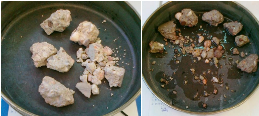
Figure 64: Test 1, échantillon avant et après traitement mécanique type MicroDeval (10 billes, 10 minutes)
