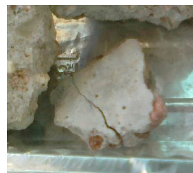
Figure 59 Test 22.1 - influence d'un refroidissement rapide à l'eau du réseau (échantillons de laboratoire)
