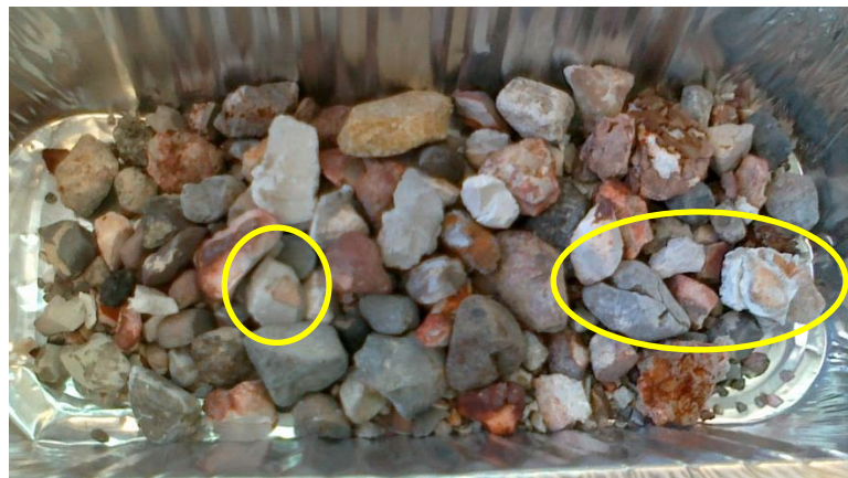
Figure 76. Observation des granulats Recybeton traités après procédé 19.4
