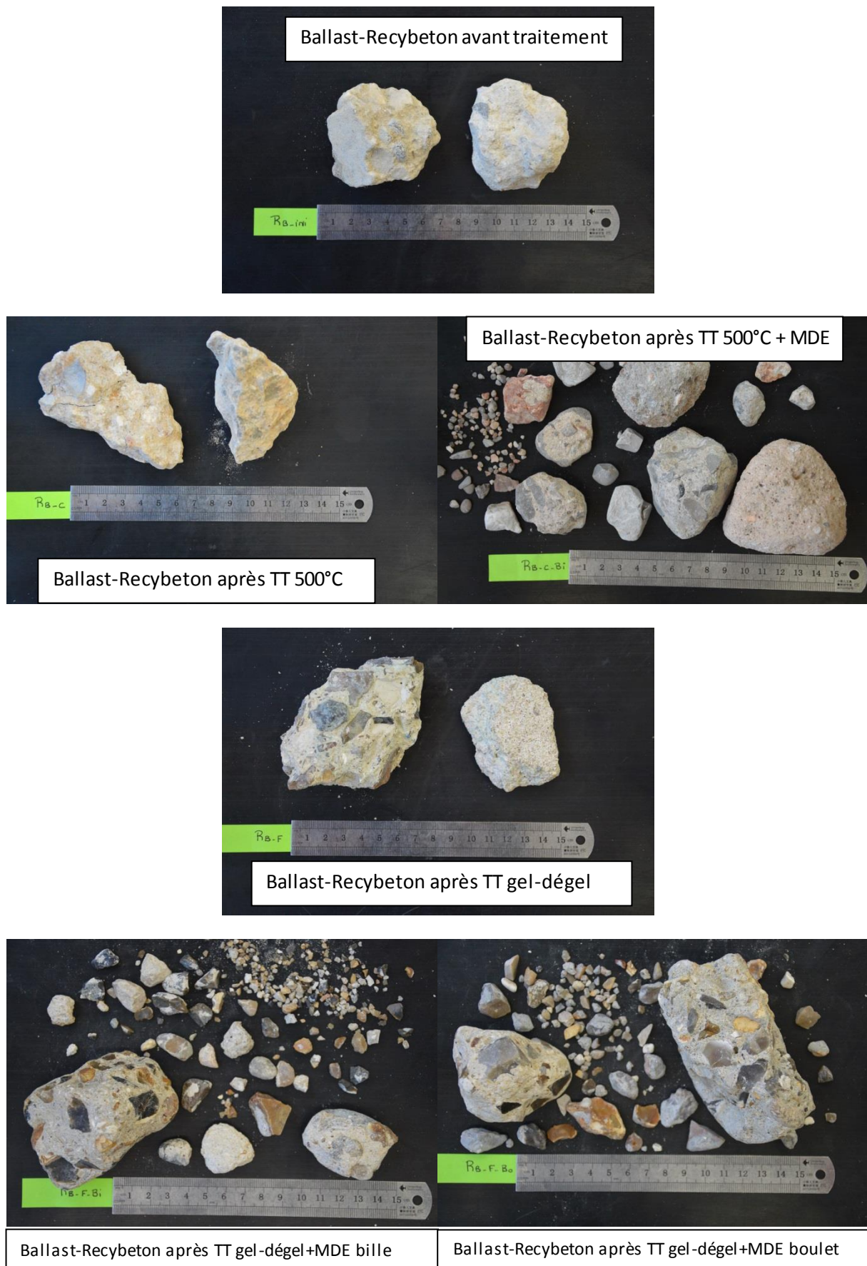
Figure 94 Evolution des RECYBETON 40/100 mm à différentes étapes du traitement – contrôles visuels
