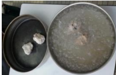
Figure 23 Refroidissement rapide des échantillons
