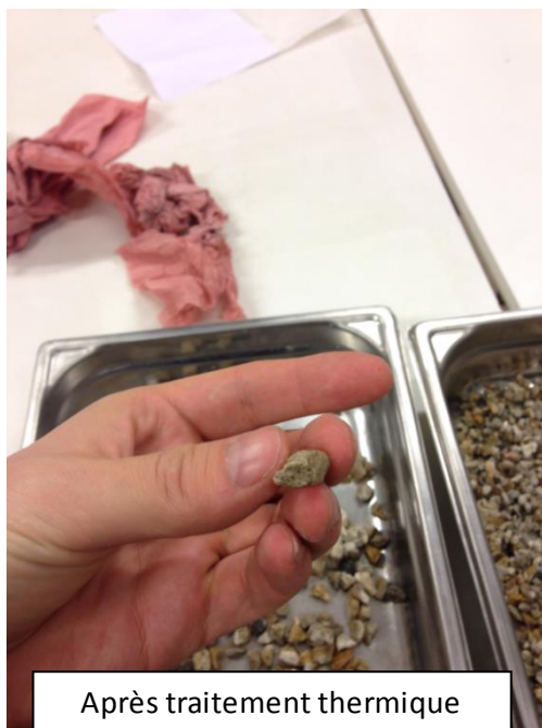
Figure 39 Observations visuelles par étape du granulat traité par cycle gel/dégel
