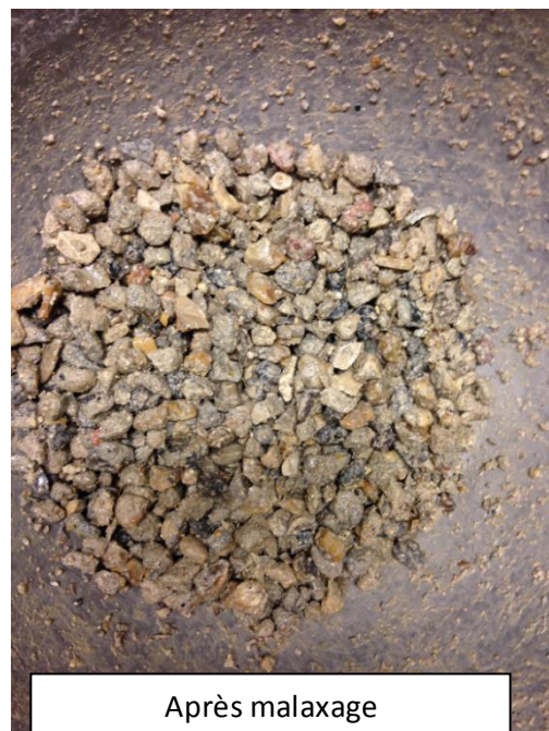
Figure 39 Observations visuelles par étape du granulat traité par cycle gel/dégel
