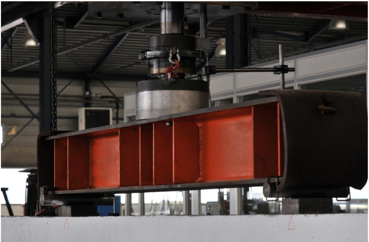
**Fig. 3.5**      Détail palonnier de chargement.
