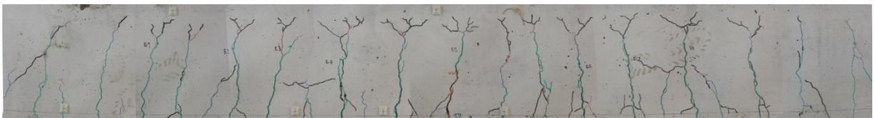
**Fig. 8.3** Faciès de fissuration poutre *RB-03*.
