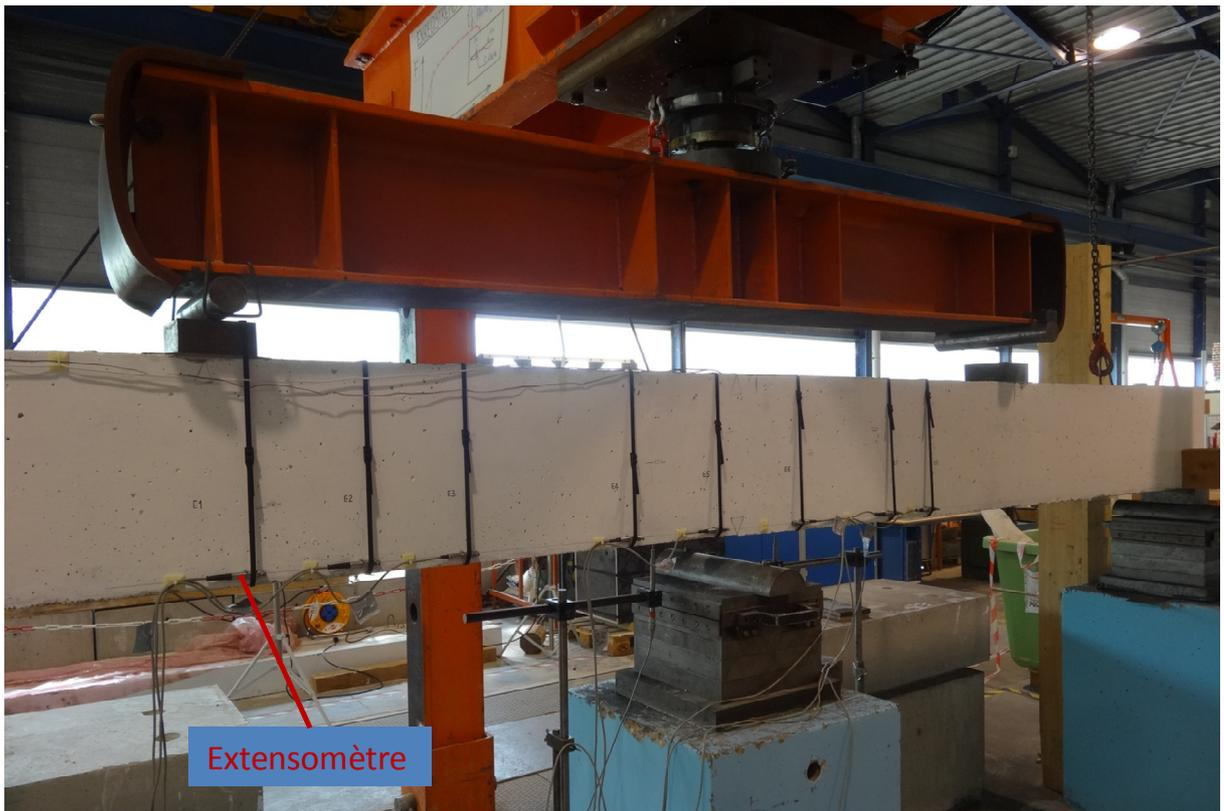
**Fig. 3.7** Capteurs d'ouverture des fissures : vue d'ensemble.
