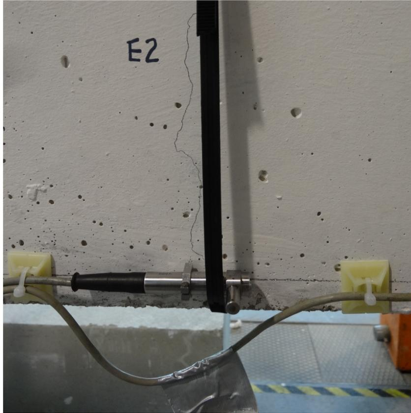
**Fig. 3.8** Capteurs d'ouverture des fissures : détail.
