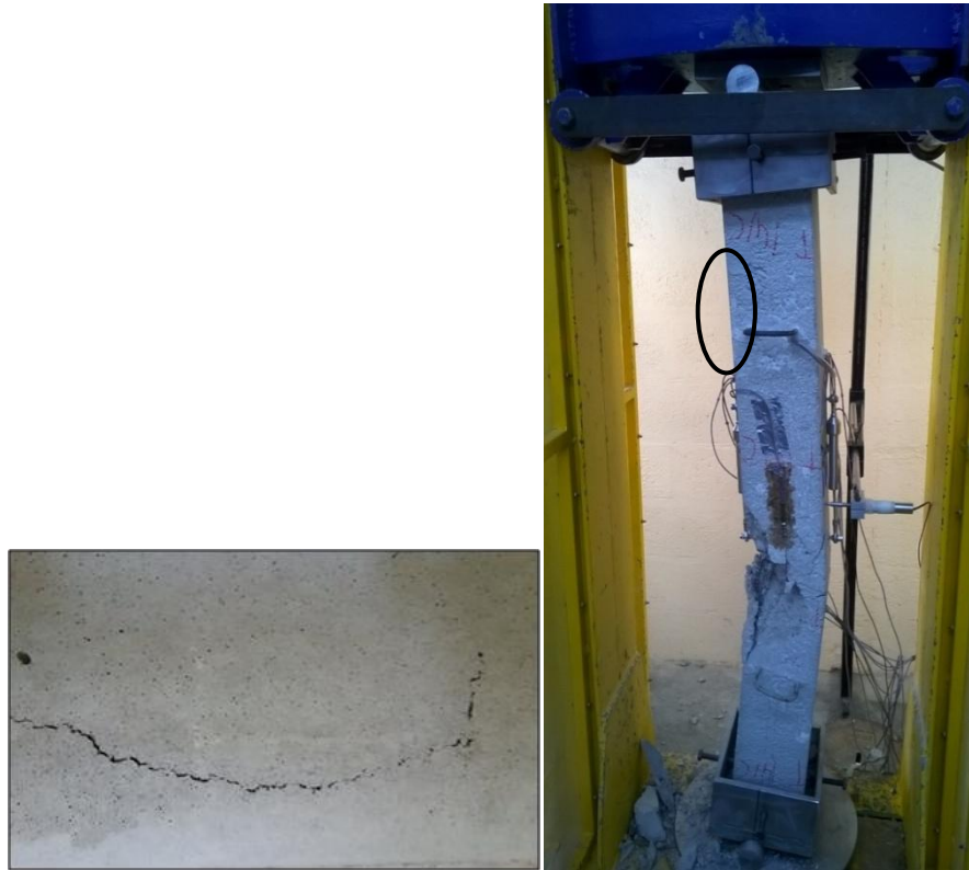
Figure 10: Une fissure sur le poteau 100 R – 100 R.
