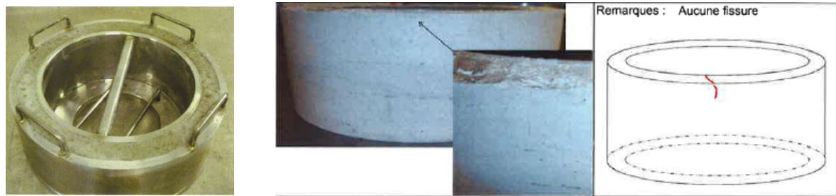
Figure 5 : Essais de retrait empêché à l'anneau effectués par Sigma Béton. Fissuration sur la formulation 100S 100G.
