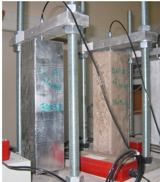
Figure 2. Mesure du retrait libre avec acquisition automatique : éprouvette recouverte d'une double couche d'aluminium adhésif (à gauche) pour le suivi du retrait endogène, éprouvette revêtue seulement sur ses faces supérieure et inférieure pour le suivi du retrait total.
