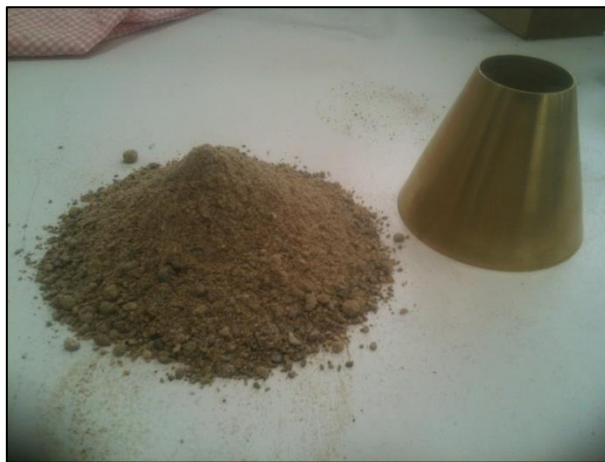
Figure 8 : Exemple de sable caractéristique pour mesure d'absorption selon la norme NF 1097-6
