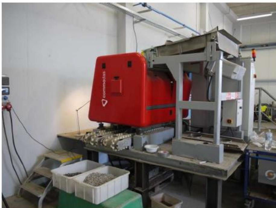
La fraction 6-20mm est triée en utilisant une « Combisense chute ».
