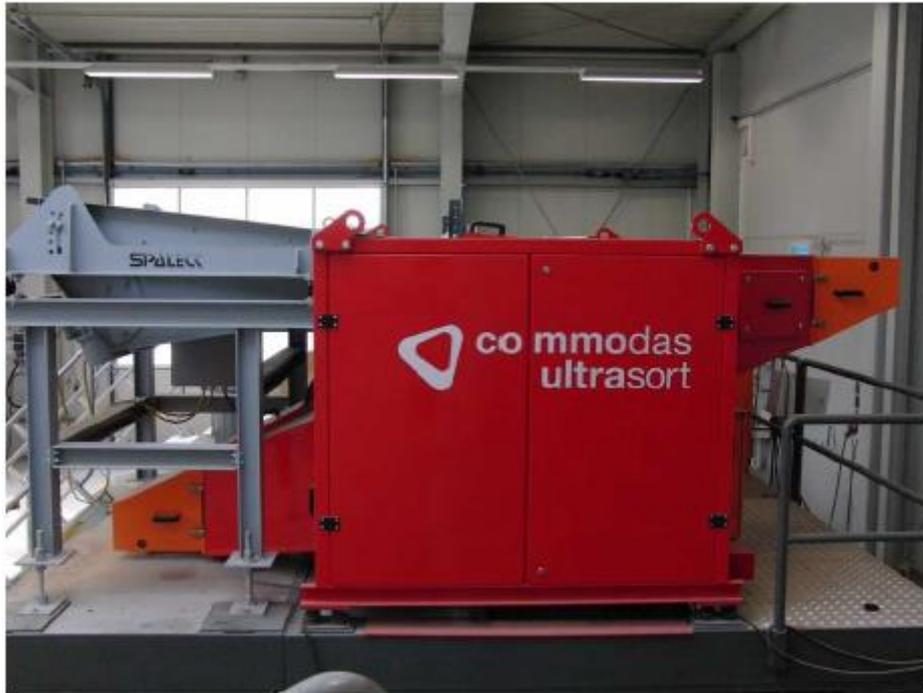
La fraction 20-80mm est triée en utilisant un trieur PRO COLOR tertiaire avec deux caméras pour détecter les pierres des deux côtés.
