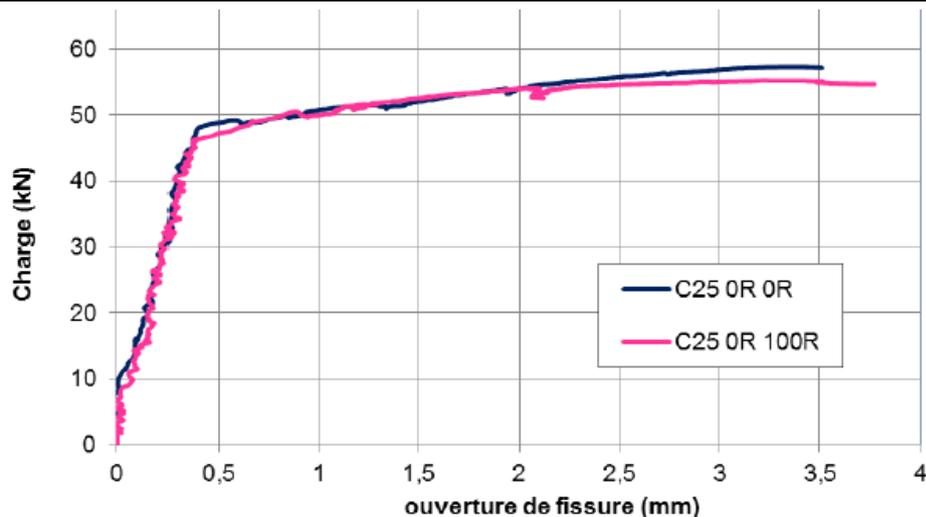
Figure 9. Ouverture de fissure en fonction du chargement
