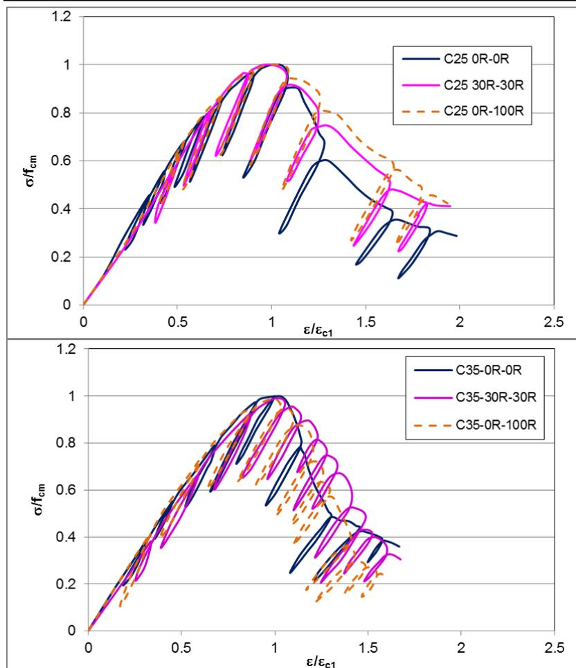
Figure 10. Comportement du béton lors des cycles chargement-déchargement
