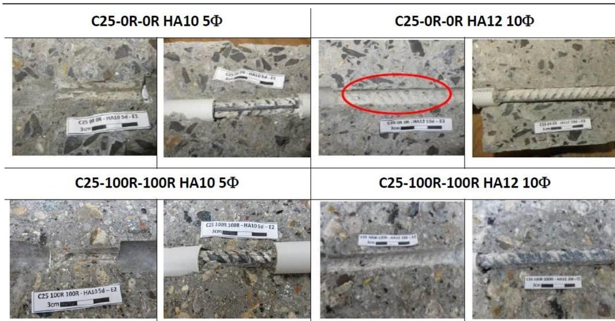
Figure 7. Etat de l'interface acier/béton pour la série C25/30
