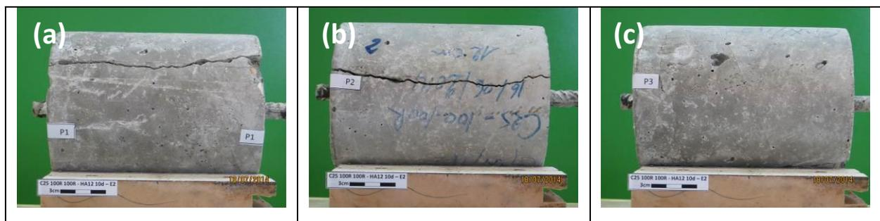
Figure 19 – Photographies de l'éprouvette C25-100R-100R HA12 10Φ. Vues de côté : (a) Face P1, (b) face P2 et (c) face P3.
