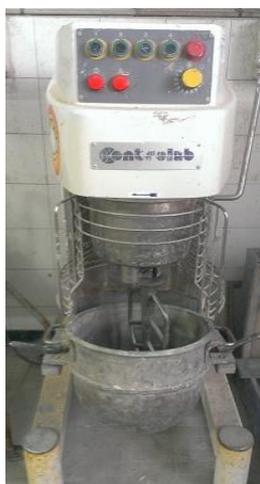
Figure 35 : Malaxeur Controlab de capacité 10 litres
