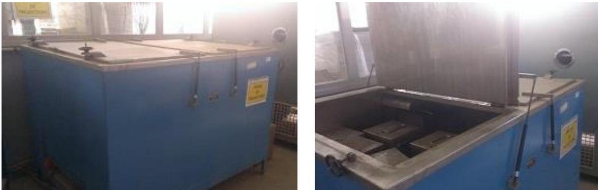
Figure 36 : Réacteur thermostaté à 60°C ( $\pm 2^\circ\text{C}$ )
