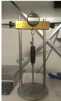
Figure 37 : Système de mesure de longueur axiale : rétractomètre
