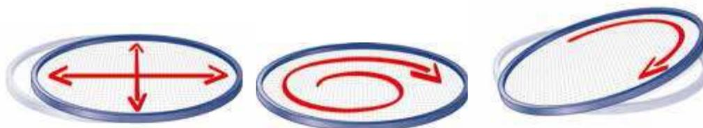
**Figure 11.** Superposition des mouvements du tamis à nutation [60]
