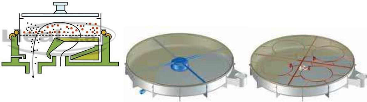
**Figure 15.** (Gauche) Systèmes de décolmatage par aspiration [66], (centre) par jets d'air sous pression [60] et (droite) par ultrasons [60]
