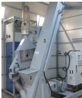
Figure 19 – Jig à air de laboratoire (gauche) [Boylu, 2014] et jig à air industrielle [Oder, 2003].
