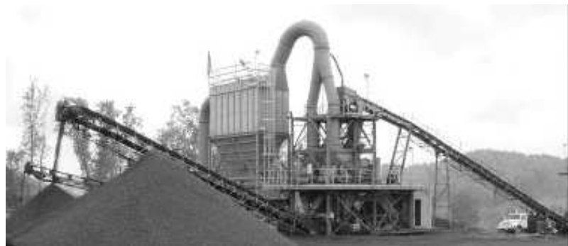
Figure 19 – Jig à air de laboratoire (gauche) [Boylu, 2014] et jig à air industrielle [Oder, 2003].
