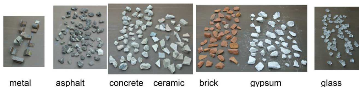
Figure 83 – Mise en place des particules de matériaux traitées par Comex.
