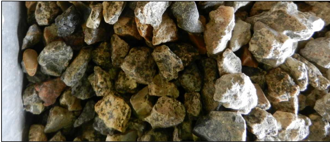
Figure 7 : Fines de ciment collées aux granulats
