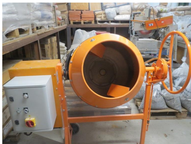
Figure 2 - Bétonnière équipée de variateur de fréquence
