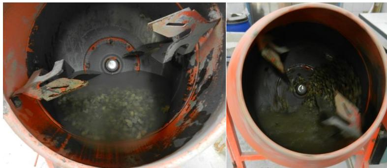
Figure 3 : Bétonnière employée pour la partie brassage de l'étude, à l'arrêt (à gauche) et en cours de brassage (à droite)
