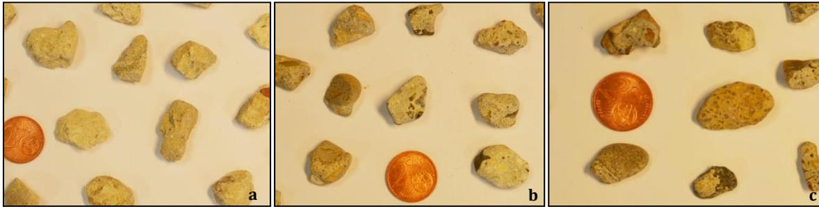
Figure 20 : Photos des granulats 10/14 avant l'essai Micro-Deval (a) et après 7500 (b) et 100000 (c) tours d'essai Micro-Deval
