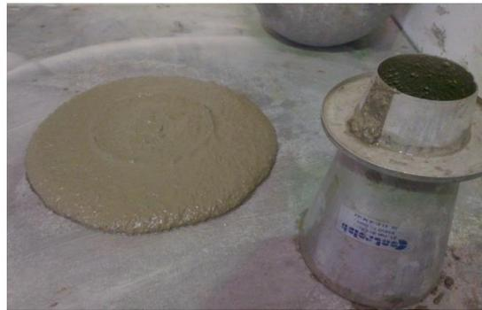
Figure 11. Essai au mini-cône
