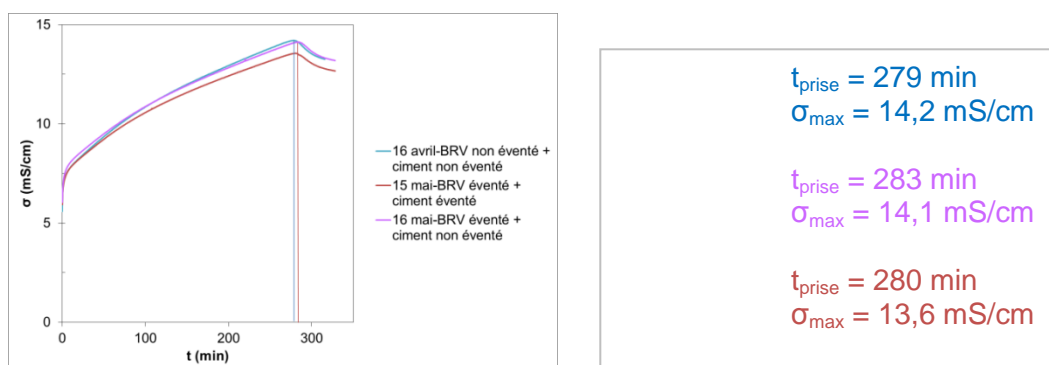
Figure II-10 : courbes de conductivité électrique du mélange 70 % de ciment et 30 % de BRV non éventé ou éventé
