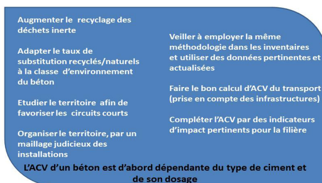
Figure 7 illustration des recommandations pour inciter à l'utilisation de granulats recyclés dans les bétons au regard de l'évaluation environnementale.
