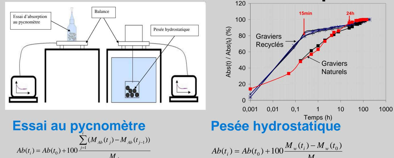
Avec:  $Ab(t_i)$  absorption à chaque pas de temps  $t_i$ ,  $Ab(t_0)$  absorption d'eau à  $t_0$ =5min,  $M_{Ab}(t)$  Masse du pycnomètre rempli d'eau et  $M_w(t)$  Masse de l'échantillon dans l'eau.
