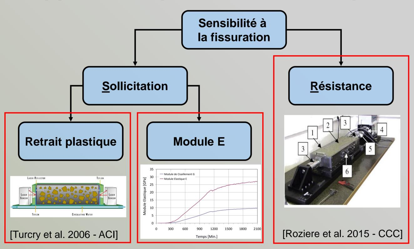
Contraintes internes développées > Résistance en traction => Fissuration
